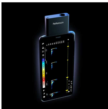
Figure 5 : Microphone à ultrasons u384 (Pettersson AB) utilisé dans le cadre de l'étude ( www.batsound.com )
