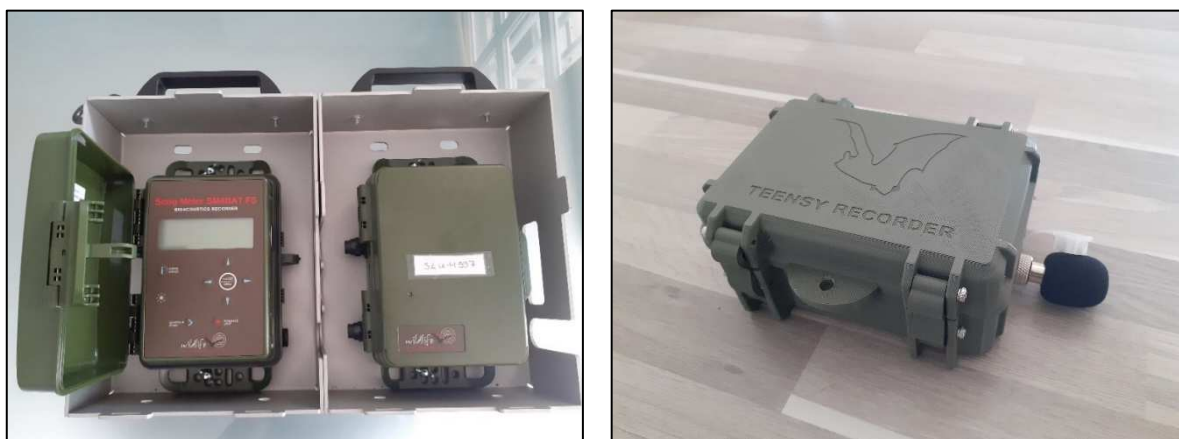
Figure 6 : Matériel utilisé pour les enregistrements passifs – enregistreur SM4 FS (Wildlife Acoustics Inc., à gauche) et Passive Recorder (Teensy Recorders, à droite)
